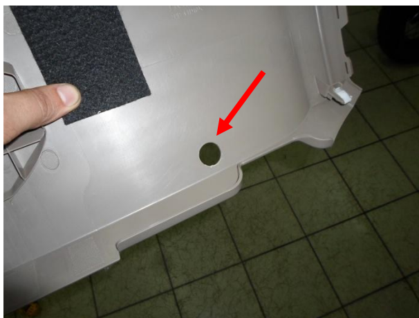
Разметить и выполнить отверстие в панели.
