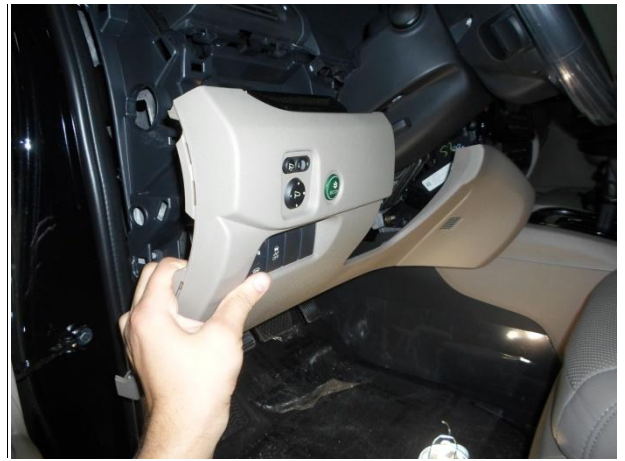
Снять панель, отсоединить фишки.
