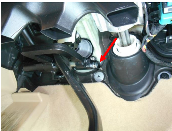
Притянуть замок к кронштейну срывным болтом.
