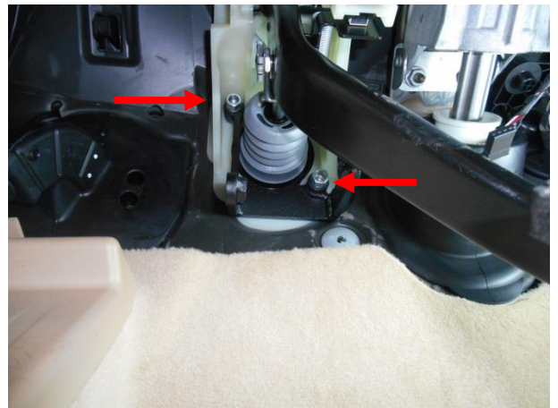
Вывернуть болты крепления вакуумного усилителя и установить кронштейн, затянув срывными гайками.
