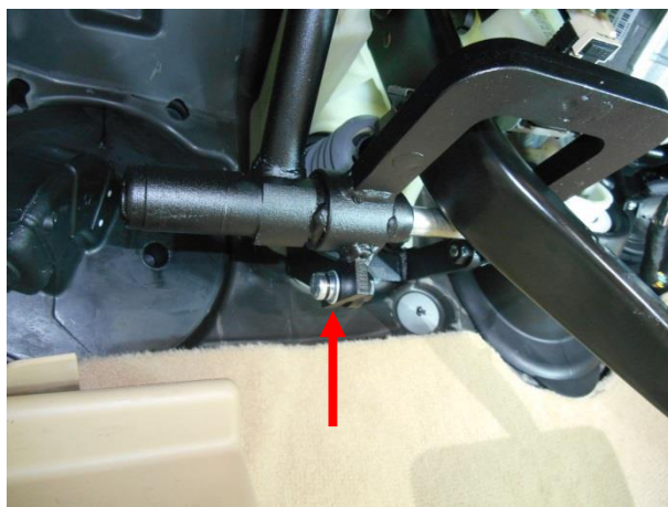
Притянуть замок к кронштейну срывным болтом.
